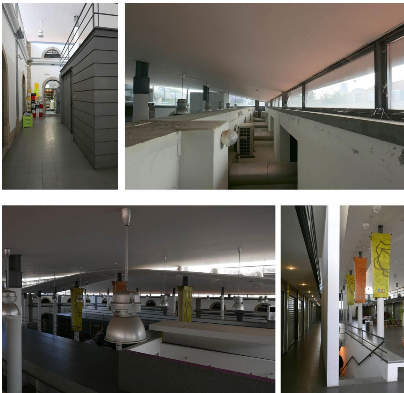
Figura 34. Mercado Municipal de Évora. Imagens actuais do interior do edifício do Mercado de Frescos incluindo escala do espaço entre novo corpo construído no interior e fachadas existentes para o pátio, galeria técnica superior, vista do tecto falso que difunde a luz zenital e esconde parcialmente as condutas de insuflação da climatização do mercado, e escadas de acesso às novas mezzanines interiores. Imagens Luís Tavares Pereira, Outubro 2016.
